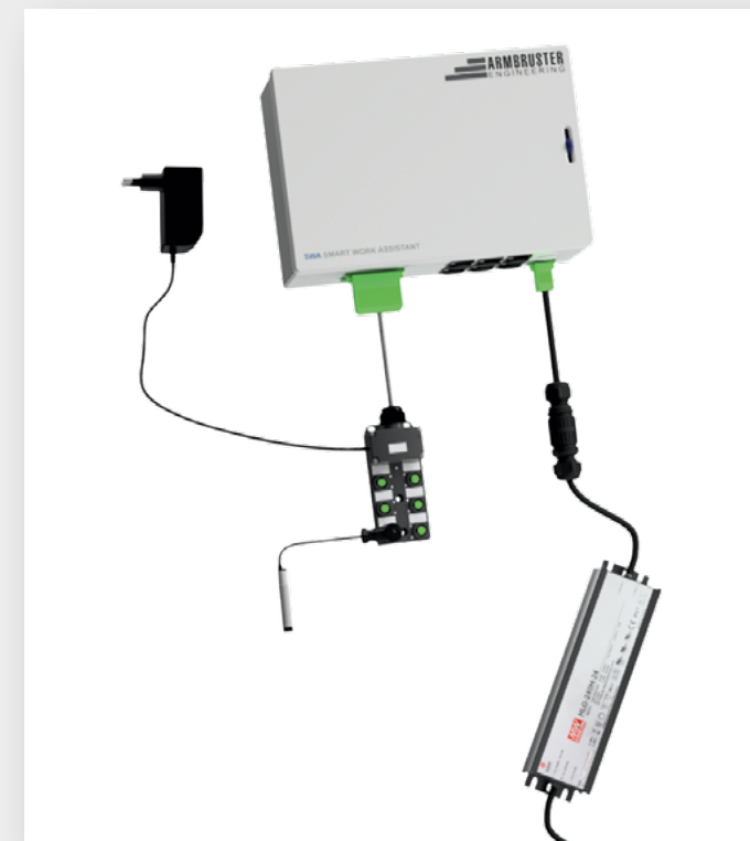
Sensorinsel für bis zu 6 Sensoren, angebunden am SWA mit Netzteil
